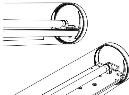
G / Mettre le tubulaire dans les colliers puis, les refermer avec les joints de verrouillage.
