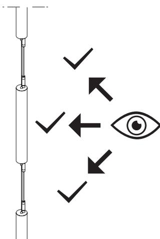
J/ Le filin d'acier qui se trouve au centre des luminaires sert à la suspension des luminaires. L'installation ne doit en aucun cas être suspendu par les câbles électriques, ni par les connecteurs. Il est indispensable à ce que le filin de suspension soit plus court que le câble électrique. Le câble électrique ne doit être en aucun cas tendu.
