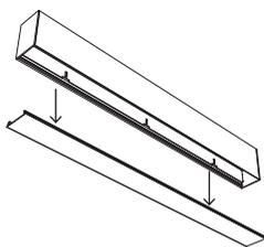
A / Retirer le diffuseur. Si besoin, l'enlever à l'aide d'un tournevis plat au niveau des embouts pour faire levier. Ne pas forcer sur les embouts.
