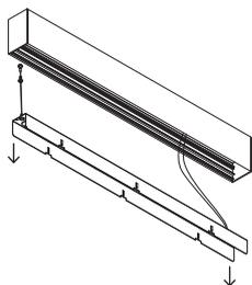
B / Retirer la platine en la faisant glisser avec les mains vers l'extérieur de l'appareil. Si besoin, l'enlever à l'aide d'un tournevis plat en détachant LÉGÈREMENT
