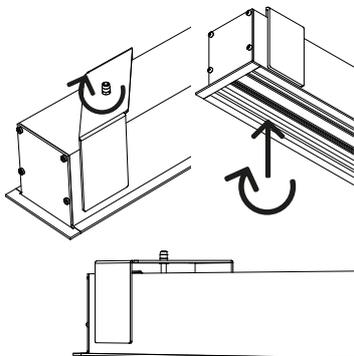
H/ Dénuder votre câble. Présenter la platine en face du corps puis connecter au bornier (voir p. 3. CÂBLAGE).
