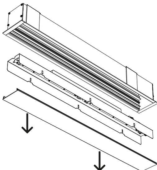
D / Desserrer les drapeaux à l'aide d'un tournevis cruciforme.
