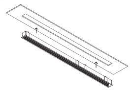
H/Serrer les vis des drapeaux pour fixer le luminaire.
