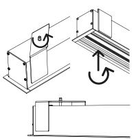
E/Assembler les corps entre eux à l'aide des éclisses. Puis les fixer avec les vis sans tête M5×8 (fournies). Utiliser une clé six pans n°2,5. Attention : un serrage abusif peut entrainer une déformation du corps alu.
