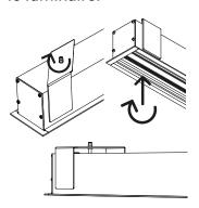
I/Dénuder votre câble. Présenter la platine en face du corps puis connecter au bornier (voir p. 3. CÂBLAGE).
