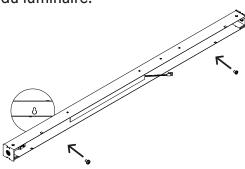
D/Passer le câble d'alimentation par l'embout côté bornier.
