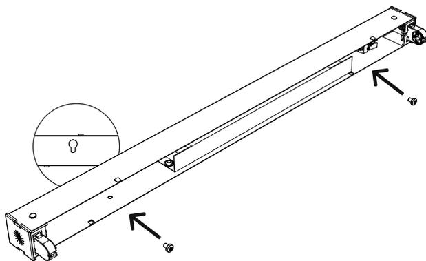
C/Passer le câble d'alimentation par l'embout côté bornier.
