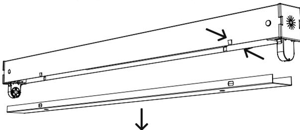
B/Fixer le luminaire au support à l'aide de 2 vis (non fournies) par les deux trous de serrure situés à l'arrière du corps du luminaire.
