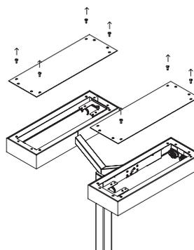
E / Installer les tubes puis repositionner le polycarbonate.
