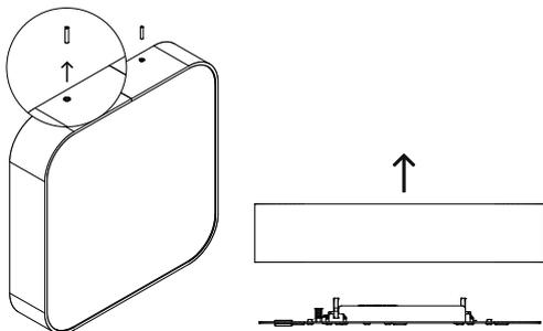
B/ Fixer la platine sur le mur avec 3 vis Ø 4 mm (non fournies), en faisant attention à bien passer votre alimentation dans le passe-câble.
