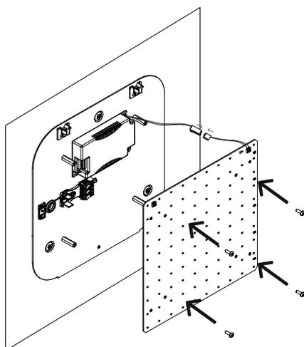
E/ Remettre le capot en l'inclinant sur le dessus et en le faisant basculer vers le bas.
