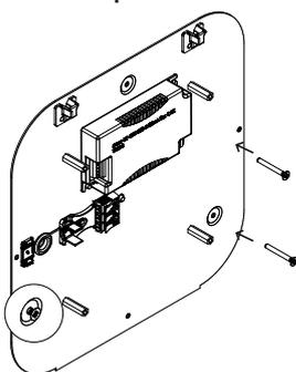
C/ Dénuder votre câble, connecter les fils au bornier (voir 3. CÂBLAGE).
