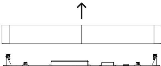
C/ Fixer la platine sur le mur avec 2 vis Ø 4 mm (non fournies), en faisant attention à bien passer votre alimentation dans le passe-câble.
