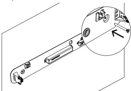
D/ Dénuder votre câble, ouvrir le capot du bornier, connecter et refermer celui-ci (voir 3. CÂBLAGE).
