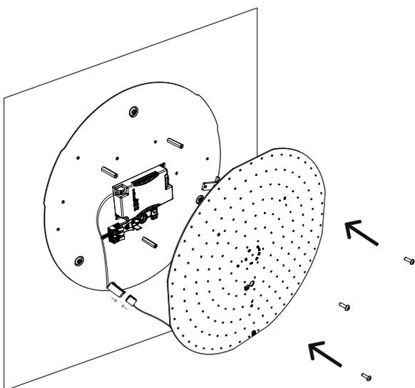
D / Positionner la capot à l'aide des détrompeurs puis tourner dans le sens des aiguilles d'une montre jusqu'au « clic ».
