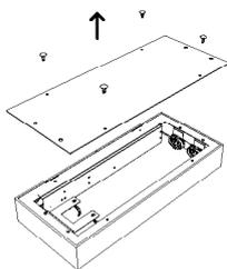
A / Retirer les rivets plastiques puis ôter le diffuseur supérieur de l'applique.
