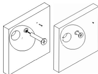
D / Positionner l'appareil entre le mur et les vis en faisant attention à passer votre alimentation par le passe-câble. Puis serrer les vis.
