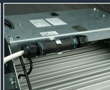
Connecteur étanche (v. avec cellule)
