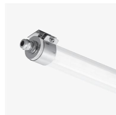
Fourreau polycarbonate Ø 40 mm. Très performant avec un IK10, un IP68 et des embouts inox. Déclinable à l'envi pour tout projet architectural ingénieux.
