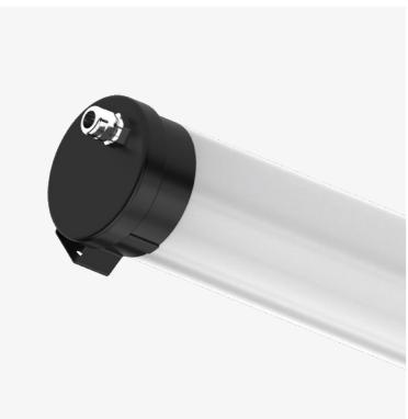
Fourreau en co-extrudé, Ø 100 mm. Embouts en aluminium et colliers inox peints. IP69K, IK10. Capable d'affronter des températures de -20°C à +60°C, il saura garder son sang-froid en toute situation !
