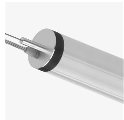
Corps en polycarbonate anti-UV opale, diamètre 70 mm. Platine en aluminium intégrant les barrettes LED 3 000 ou 4 000 K et driver déporté pour un éclairage à 360°. Luminaire suspendu verticalement pour un effet décoratif.
