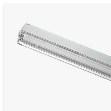
Luminaire fonderie d'aluminium de section 60 x 70 mm, nombreuses optiques possibles, LED garantie 70 000 h, montage en plafonnier, suspension ou encastré, peint en gris, gradation DALI possible.
