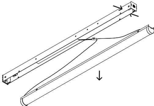
C/Fixer le luminaire au support à l'aide de 2 vis (non fournies) par les deux trous de serrure situés à l'arrière du corps du luminaire.
