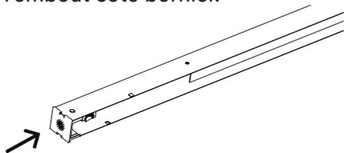
E/Raccorder le câble d'alimentation sur le bornier (voir 3.CÂBLAGE).
