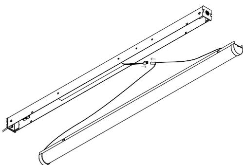
G/Repositionner le capot en poussant pour le clipper.
