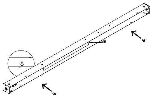
D/Passer le câble d'alimentation par l'embout côté bornier.
