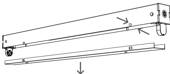
B/Fixer le luminaire au support à l'aide de 2 vis (non fournies) par les deux trous de serrure situés à l'arrière du corps du luminaire.
