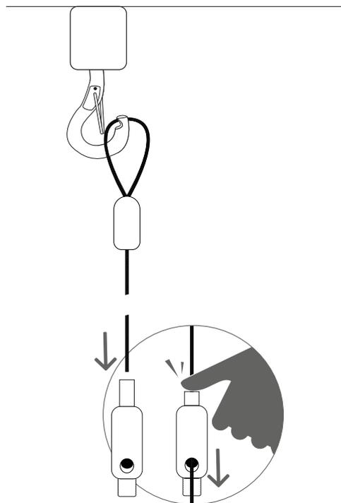
D/Passer le câble d'alimentation (Ø 11 mm maximum) dans l'appareil par le trou du passe-fils en le rentrant d'environ 50 mm.
