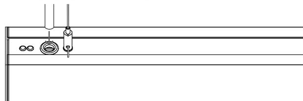
E/Dénuder votre câble. Présenter la platine en face du corps. Connecter au bornier le fil de terre présent sur le corps (voir 4. CÂBLAGE).
