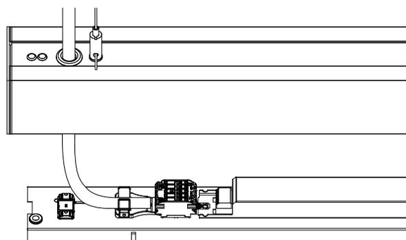
F/Clipper la platine dans le corps en appuyant uniformément sur toute sa surface afin qu'elle rentre bien droite dans le corps.
