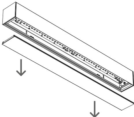
B/Retirer la platine en la faisant glisser avec les mains vers l'extérieur de l'appareil.
