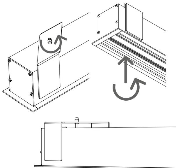
D/Passer le câble d'alimentation (Ø 11 mm maximum) par le passe-fils (en le rentrant d'environ 50 mm).
