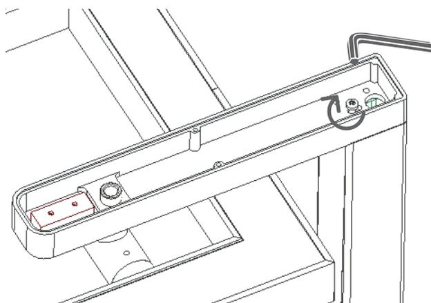
D/Replacer le cache **2** sur le bras du lampadaire. Fixer le cache à l'aide des 2 vis **3** (clé 6 pans).
