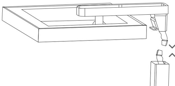
C/Maintenir la tête du luminaire sur le mat et serrer la vis (clé 6 pans) pour bloquer la tête sur le mat.
