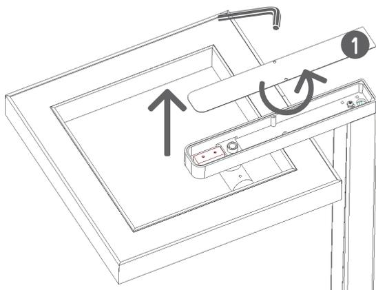
B/Brancher le (ou les) connecteurs, les placer dans le tube du mat, placer la tête du luminaire sur le mat (veiller à ne pas pincer les câbles).
