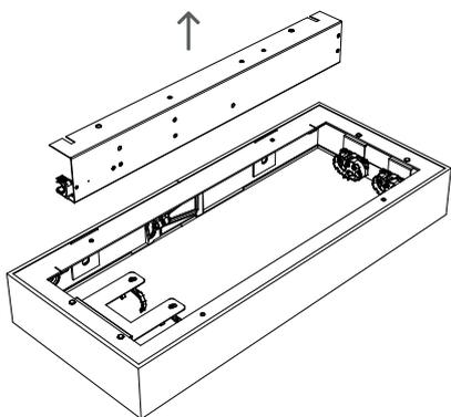
**Version LED** : Retirer les vis Ø4mm, enlever la platine LED puis ôter le porte-ballast.
