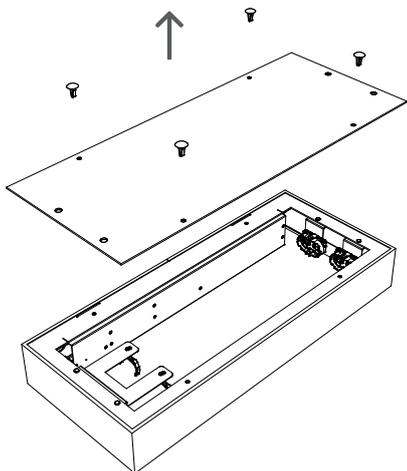
B/**Version FLUO** : Retirer les vis Ø4mm puis ôter le porte-ballast.
