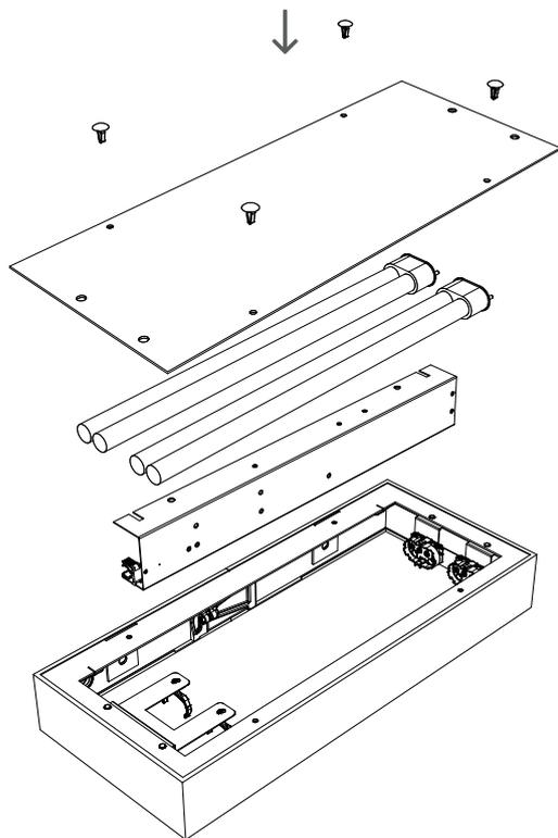
G/**VERSION LED** : Reclipser le porte ballast, la platine LED, puis remettre le diffuseur sur le dessus avec les rivets plastiques.
