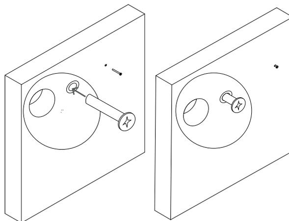
D/Positionner l'appareil entre le mur et les vis en faisant attention à passer votre alimentation par le passe-câble ①. Puis serrer les vis.
